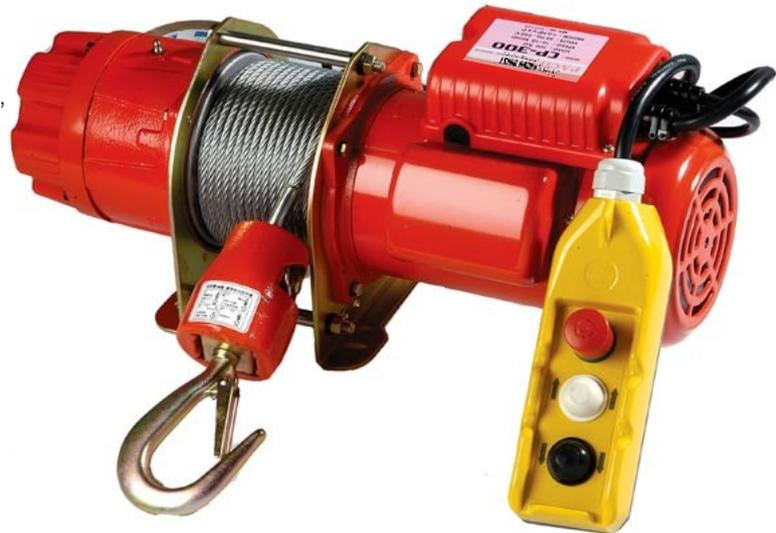
Sistema de frenado seguro y confiable, con zapatas mediante motor hidráulico, cuando haya corte de energía el freno se ajustará automáticamente. Protección de Motor IP54, contra cuerpos extraños con diámetro > 1mm y/o las salpicaduras de agua; aislamiento clase "B". Temperaturas bajo de -10°C y arriba de 40°C y/o humedad relativa de 85% podría producir fallas en el equipo, exposición a la arena puede causar un mal funcionamiento.
