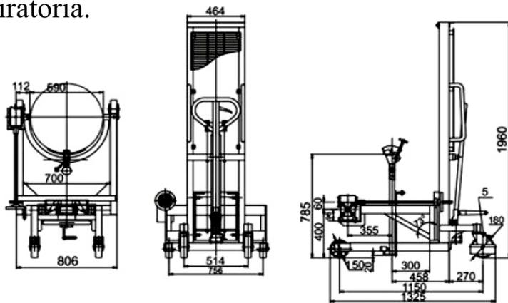
Fácil transporte mediante 2 ruedas delanteras fijas y dos ruedas traseras giratorias, además incluye frenos, el cual lo convierte en un apilador fácil de operar y alta
